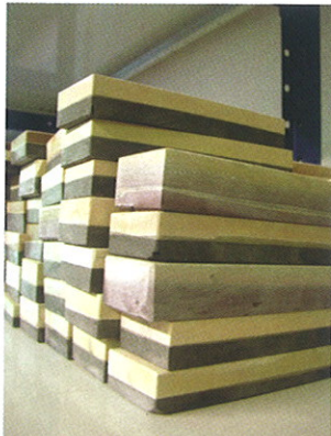
3. Après avoir été extraite, débitée et polie, la pierre à rasoir est collée sur une barre de schiste
